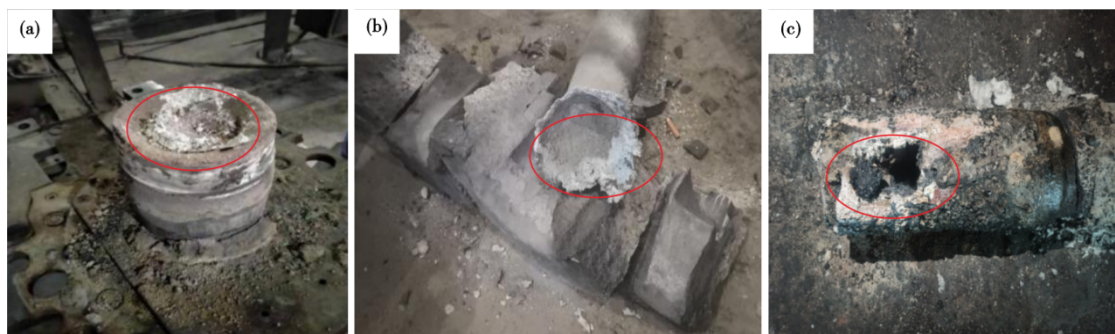
图1 水口堵的表现形式:(a)透气上水口水口碗堵塞,(b)塞棒棒头堵塞,(c)浸入水口吐出孔堵塞
